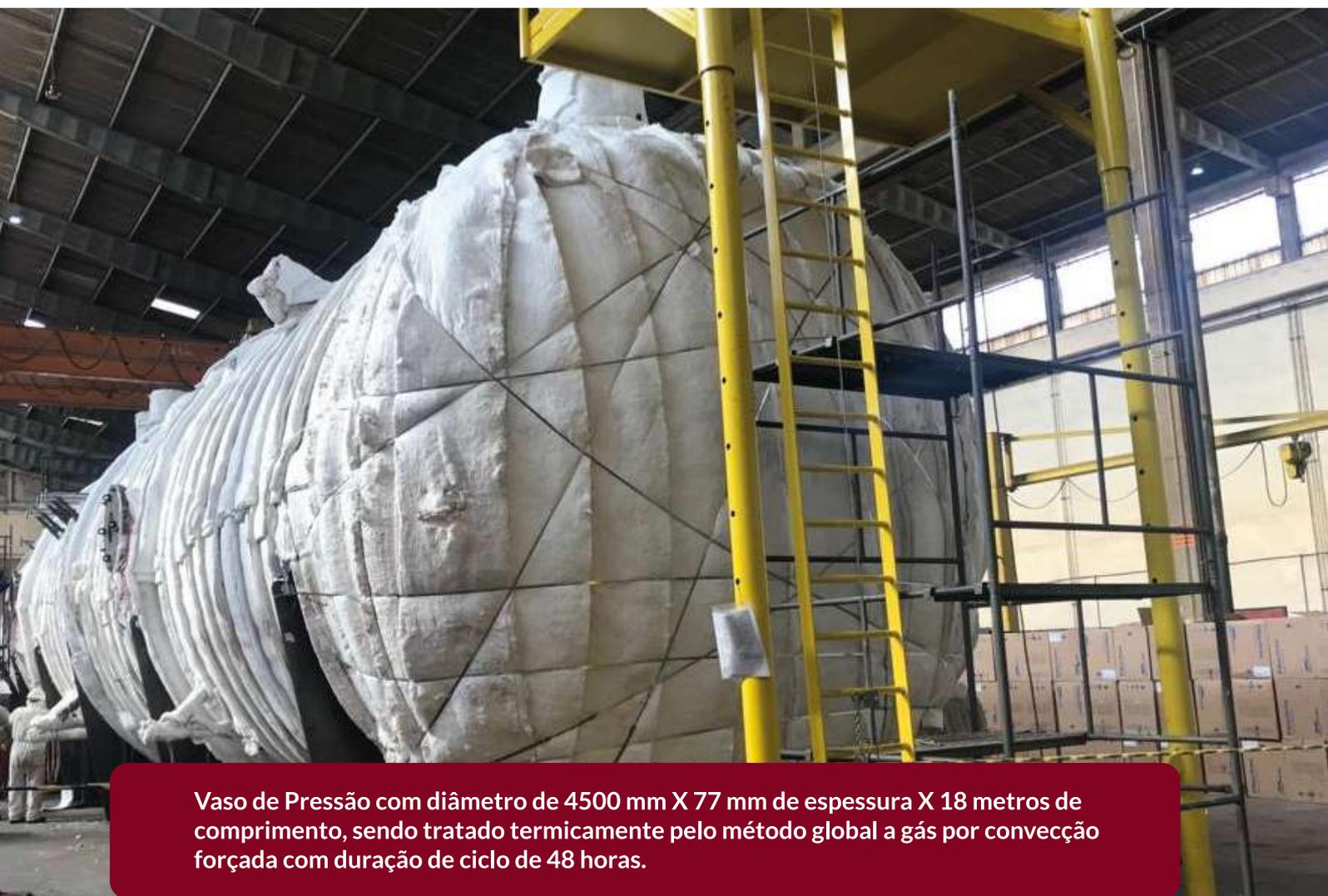
Vaso de Pressão com diâmetro de 4500 mm X 77 mm de espessura X 18 metros de comprimento, sendo tratado termicamente pelo método global a gás por convecção forçada com duração de ciclo de 48 horas.
