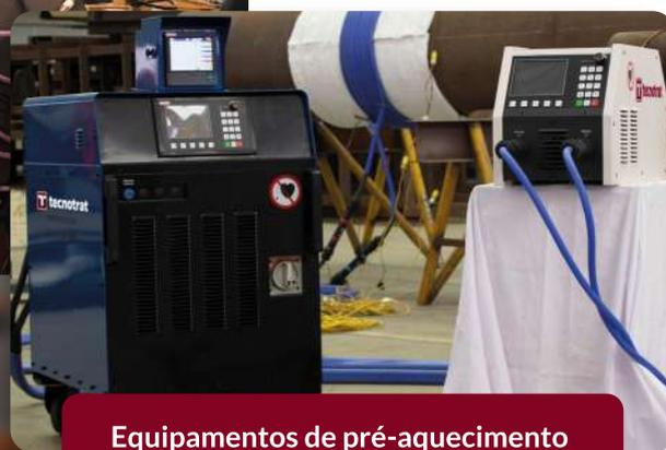
Equipamentos de pré-aquecimento e tratamento térmico por indução
