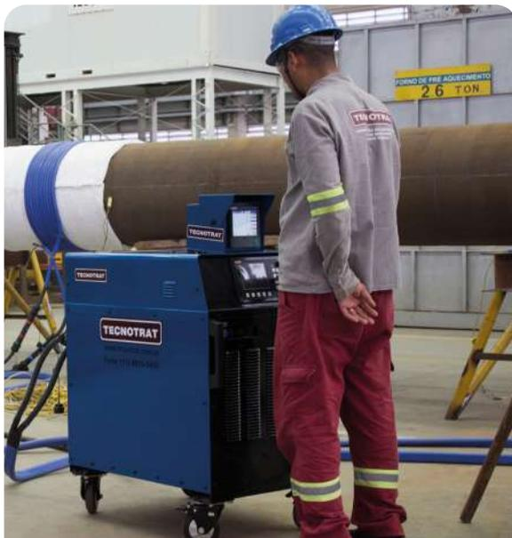
**Tratamento térmico de alívio de tensões localizado por indução em tubo de 30" x 44 mm de espessura**
