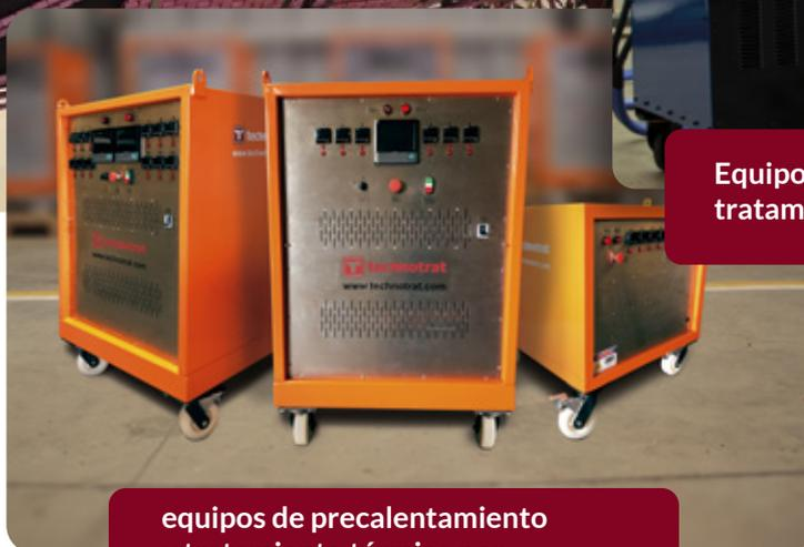
equipos de precalentamiento y tratamiento térmico por resistencias eléctricas
