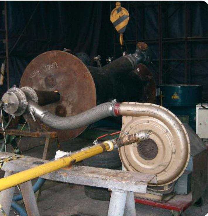
Tecnorat cuenta con equipos portátiles constituidos por quemadores de alta velocidad con calentamiento convectivo, capaces de operar tanto con gas natural como con GLP.
