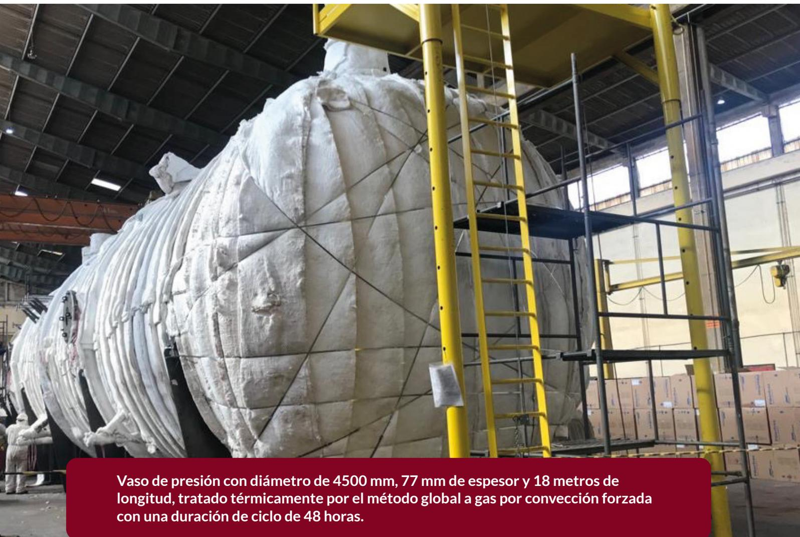
Vaso de presión con diámetro de 4500 mm, 77 mm de espesor y 18 metros de longitud, tratado térmicamente por el método global a gas por convección forzada con una duración de ciclo de 48 horas.
