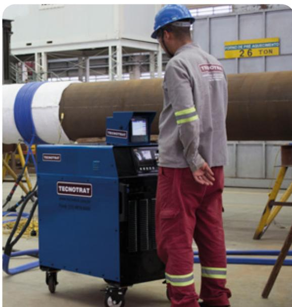
Tratamiento térmico de alivio de tensiones localizado por inducción en tubo de 30 x 44 mm de espesor
